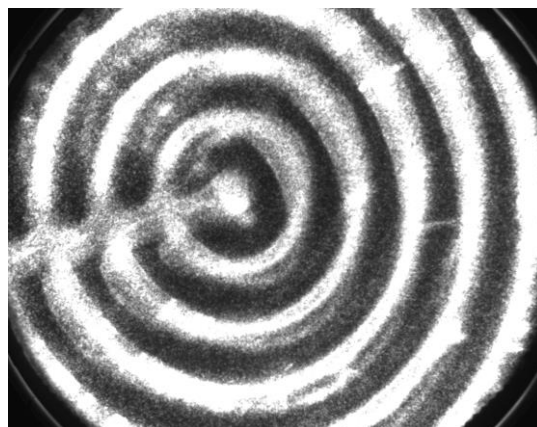
Figura 80. Imagine PEEM a unei suprafețe nano-procesate cu e-beam lithography. FOV = 16 μm.
