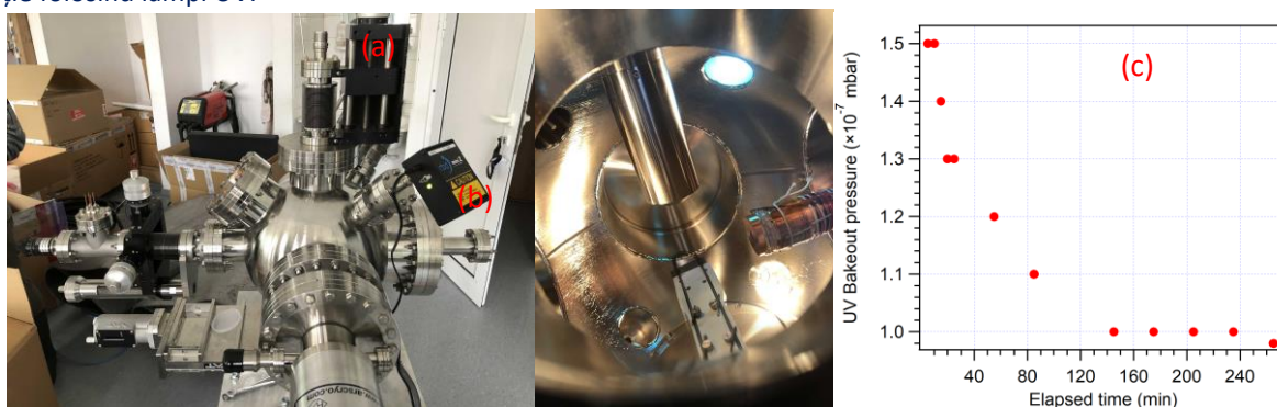
Fig. 2.3.1. (a) Lampa UV (dreapta) montata pe incinta UHV. (b) vedere din incinta in timpul functionarii lampii UV. (c) Una din evolutiile in timp ale presiunii inregistrata dupa pornirea lampii UV.
