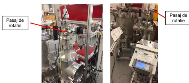
Fig. 2.9.9. Standul de testare a pasajului de rotatie
