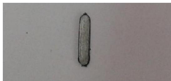
**Fig. 5.2** Magnet aproape paralelipipedic (8 mm X 2 mm X 0.5 mm, dar cu forma rotunjita la margini) obtinut prin presarea nanoparticulelor de  $\alpha''\text{-Fe}_{16}\text{N}_2$  in camp magnetic (0.8 T) aplicat perpendicular pe directia de presare, presiunea de presare fiind de 0.5 GPa
