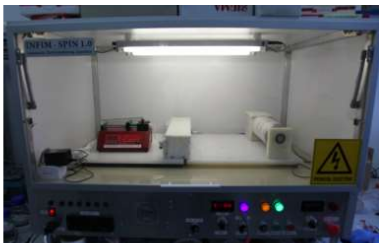
Fig. 4. Imaginea instalației de electrospinning folosită pentru a obține nanofibre polimerice aliniată.
