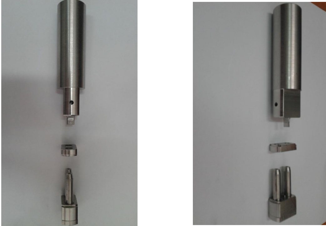
Fig. 8.1 Matrita de otel inox pentru presarea pastilelor paralelipedice in camp magnetic
