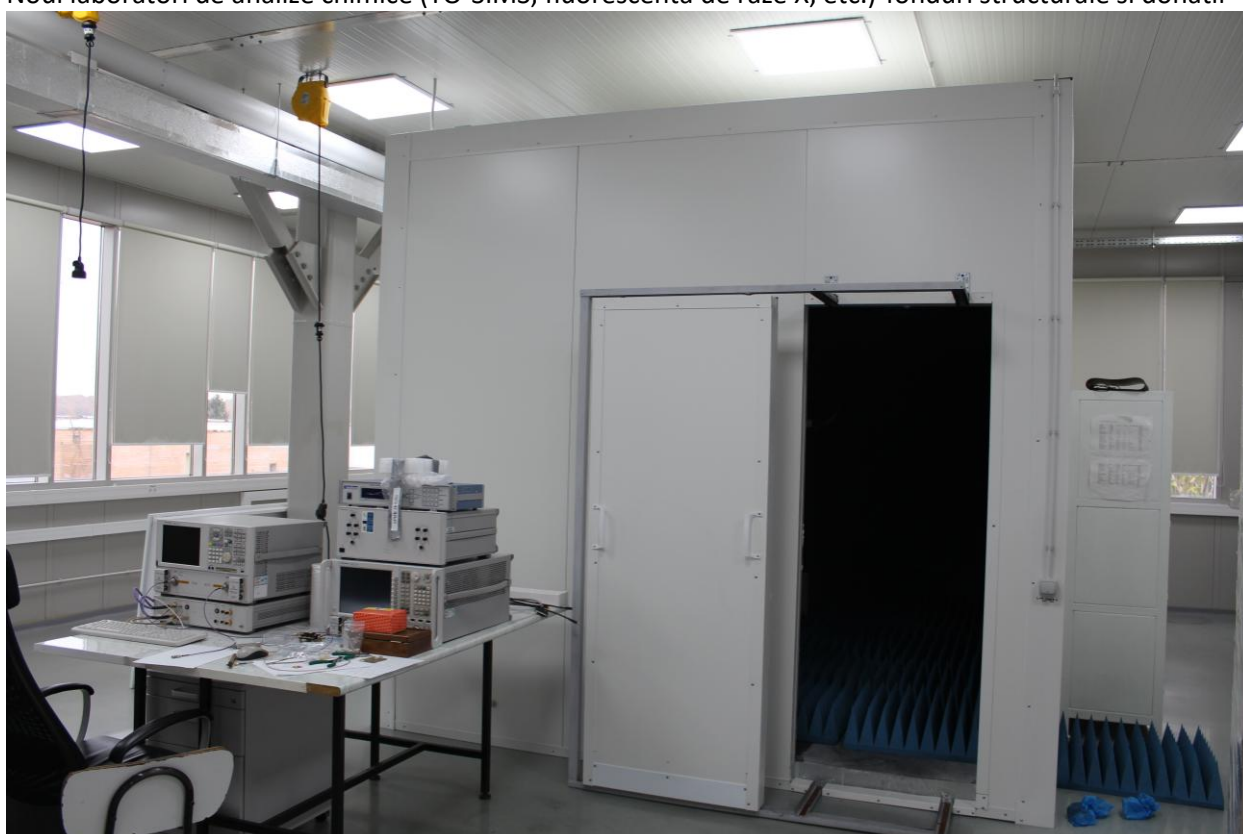
Laborator camera anecoica pentru teste dispozitive telecomunicatii microunde
