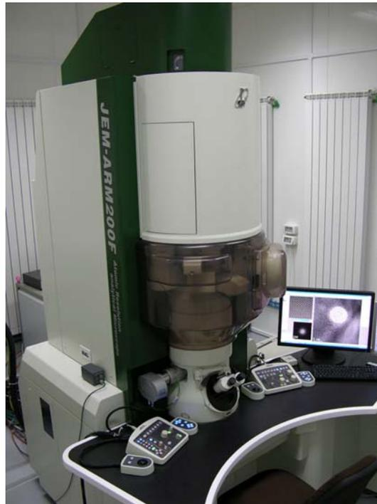
Microscop electronic analitic de inalta rezolutie prin transmisie cu corector al aberatiei de sfericitate pentru microsonda de electroni.
