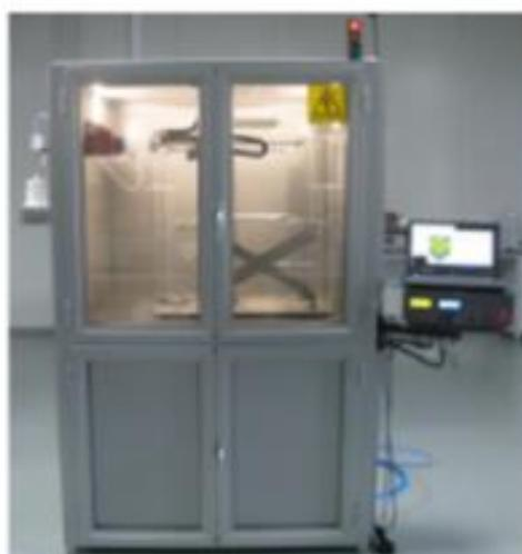
Figura 13. Instalatie de electrofilare pentru realizarea de pansamente din colagen (prototip dezvoltat in cadrul INCDFM).
