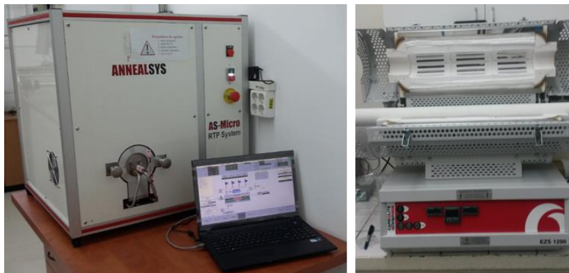
Echipament de procesare termica rapida RTP (stanga); Cuptor orizontal cu 3 zone de temperatura controlate independent (dreapta)
