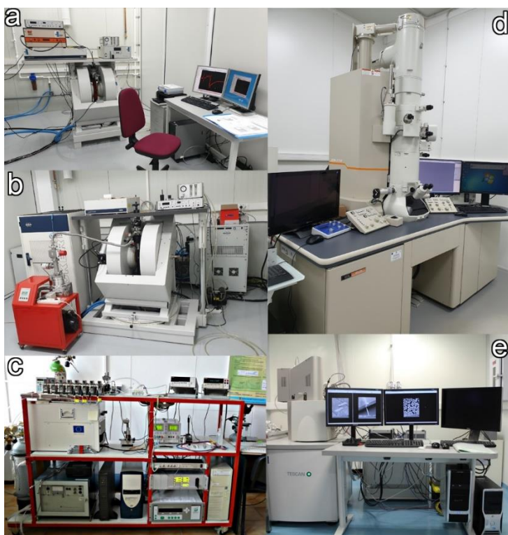
a. Spectrometru RES Bruker în banda X în regim pulsant cu accesorii ENDOR; b. Spectrometru RES Bruker în undă continuă în banda Q cu accesorii ENDOR; c. Sistem de măsurători electrice sub atmosferă controlată cu ajutorul unei stații de mixare a gazeor. d. Microscop electronic analitic de înaltă rezoluție JEM 2100; e. Sistem dual SEM-FIB Tescan Lyra III.
