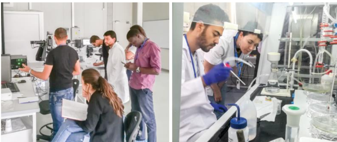
În laboratoarele INCDFM: participând la cursurile de formare pentru efectuarea măsurătorilor de elipsometrie (stânga) și verificarea compușilor de reacție intermediari pentru dezvoltarea de noi materiale luminescente de tip anti-Stokes sub îndrumarea CSII Florentina Neațu (dreapta).
