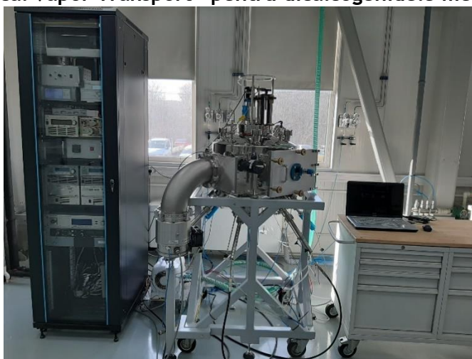
Echipment hybrid de "Magnetron Sputtering - Pulsed Laser Deposition" pentru filme subtiri
