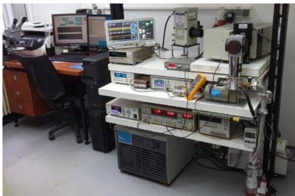
Standuri de masurari: electrice si fotoelectrice (stanga); Hall (dreapta)
