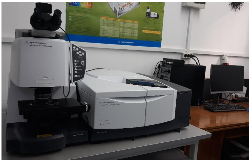
Spectro-microscop de infrarosu, Cary 600 de la Agilent Technologies
