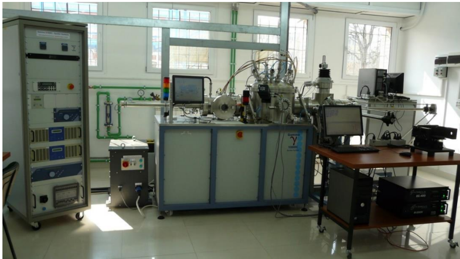
Echipament de pulverizare cu magnetron, prevazut cu tehnici de analiza in situ a suprafetei constand in spectroscopie de electroni Auger - AES si difractie de electroni de energie joasa - LEED, precum si cu monitorizare elipsometrica in situ in timp real
