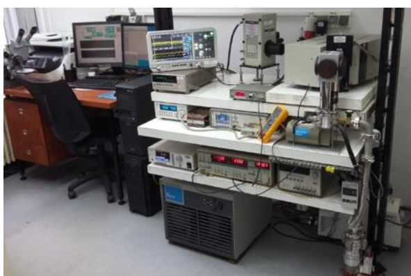
Echipament de procesare termica rapida RTP (stanga); Cuptor orizontal cu 3 zone de temperatura controlate independent (dreapta)
