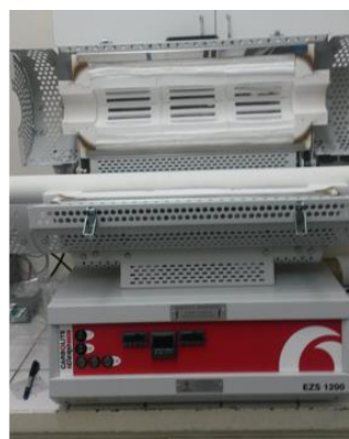
Echipament de procesare termica rapida RTP (stanga); Cuptor orizontal cu 3 zone de temperatura controlate independent (dreapta)
