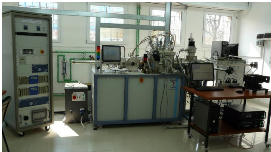
Echipament de pulverizare cu magnetron, prevazut cu tehnici de analiza in situ a suprafetei constand in spectroscopie de electroni Auger - AES si difractie de electroni de energie joasa - LEED, precum si cu monitorizare elipsometrica in situ in timp real
