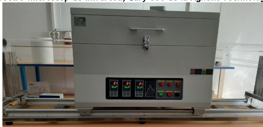
Echipament "Physical Vapor Transport" pentru dicalcogenidele metalelor tranzitionale
