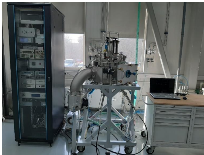
Echipment hybrid de “Magnetron Sputtering - Pulsed Laser Deposition” pentru filme subtiri
