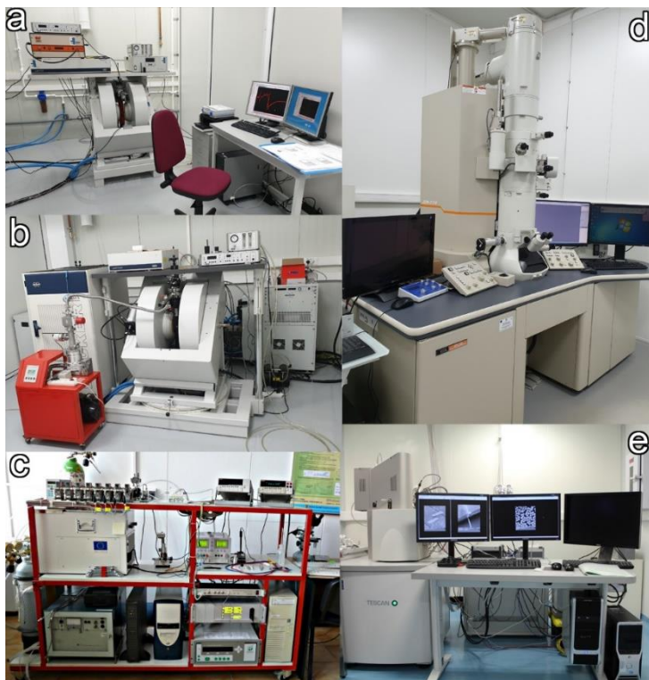
a. Spectrometru RES Bruker în banda X în regim pulsat cu accesorii ENDOR; b. Spectrometru RES Bruker în undă continuă în banda Q cu accesorii ENDOR; c. Sistem de măsurători electrice sub atmosferă controlată cu ajutorul unei stații de mixare a gazelor. d. Microscop electronic analitic de înaltă rezoluție JEM 2100; e. Sistem dual SEM-FIB Tescan Lyra III.
