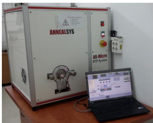
Echipament de procesare termica rapida RTP (stanga); Cuptor orizontal cu 3 zone de temperatura controlate independent (dreapta)
