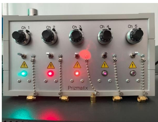
Fig. 2.4 stanga: Caracteristici I - V la intuneric si sub iluminare cu lumina monocromatica, \lambda = 500 \text{ nm} , 655 \text{ nm} , 760 \text{ nm} , 870 \text{ nm} , 940 \text{ nm} ; dreapta: dispozitive LED pentru lumina monocromatica.
