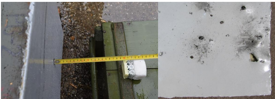
Fig. 1. Amplasarea încărcăturilor explozive în fața pachetelor balistice, vedere din lateral (stânga) și Pachetul balistic după realizarea testării (dreapta)
