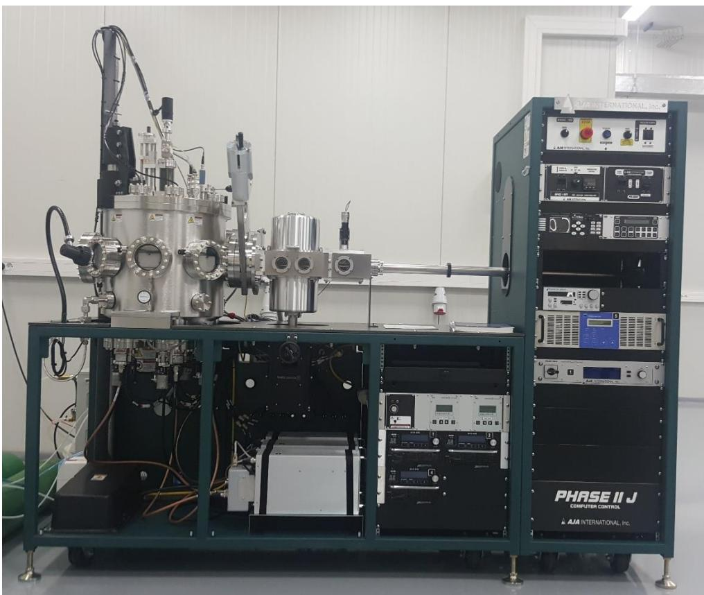
Instalatie noua de pulverizare in radio-frecventa cu magnetron.
