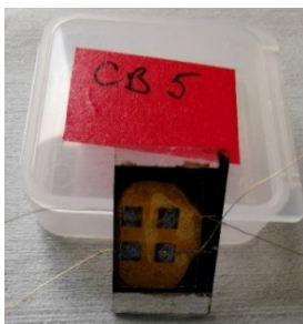
Figura 2. Proba cu 4 celule solare, încapsulate cu rășina epoxidică și placuță de sticlă peste electrozii de aur
