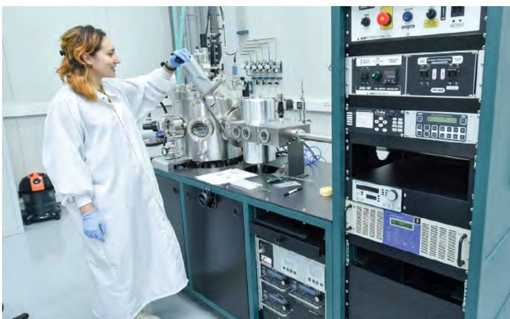
Dr. Cristina Beșleagă Stan și echipamentul nou achiziționat în 2016 pentru depunere de straturi subțiri prin pulverizare magnetron (5 catozi, diam. de 2 și 3 inch) RF-, DC-, și pulsed-DC, cu multiple facilități pentru control și monitorizare, și proces automatizat software, din centrul RITecC nou construit al INCDFM
