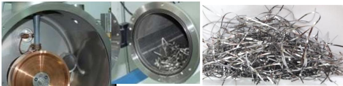
Fig.1.a) Instalatia Buehler Melt Spinner utilizata pentru a obtine benzile racite ultrarapid; b) imagine cu benzile AQ in tubul de evacuare al benzilor; c) benzi cu componititia  $Ni_{52.5}Fe_{20}Co_2Ga_{25.5}$ .
