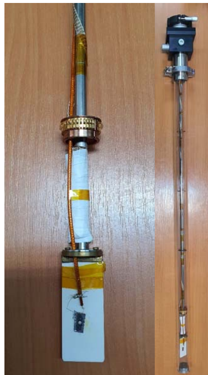
Fig. 12: Suport proba pentru măsurători ferroelectrice și de impedanță în PPMS (stanga). Intregul insert (dreapta)
