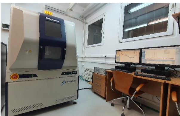
Fig. 3a Difractometrul de raze X pentru caracterizarea filmelor subțiri, model RIGAKU SmartLab 3 kW.
