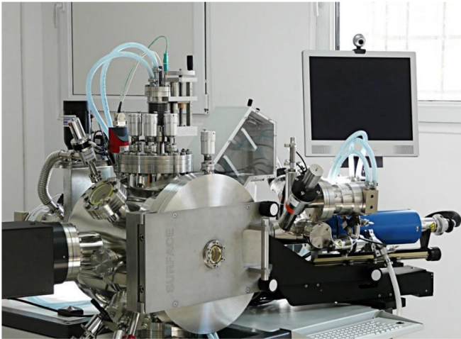
Fig. 1a Stație de lucru PLD, SURFACE SCIENCE, cu camera dedicată pentru depunerea de straturi subțiri feroelectrice.
