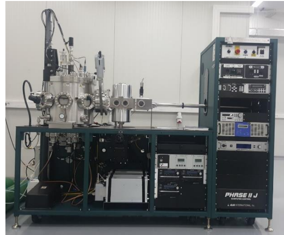
Fig. 1b Sistem de depunere a straturilor subțiri semiconductoare, AJA PHASE II J, prin pulverizare în câmp magnetron în regim RF, DC și p-DC.
