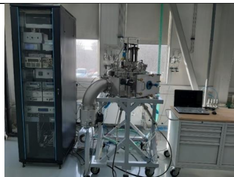
Echipament hybrid de "Magnetron Sputtering - Pulsed Laser Deposition" pentru filme subțiri
