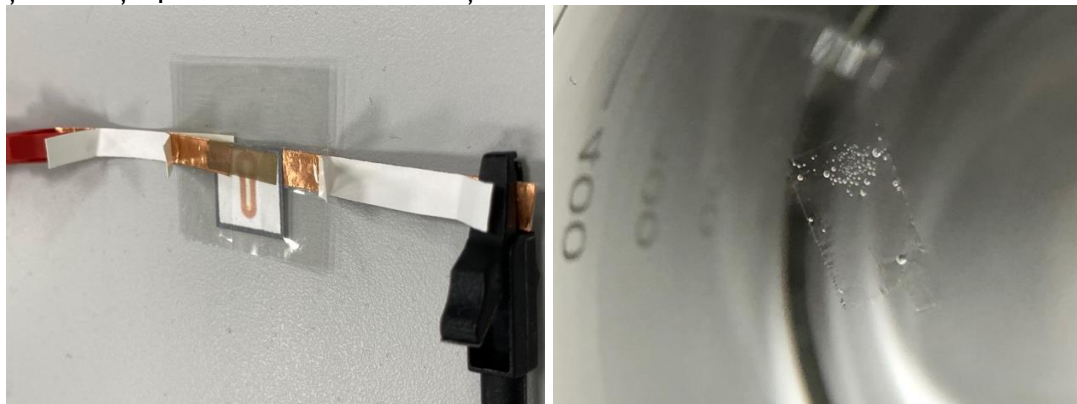
Stânga - biosenzor pe suport de hârtie și sistem de electrozi metalici fibrilari obținuți prin electrofilare; dreapta - folie de grafena/PMMA exfoliată electrochimic, pregătită de transfer
