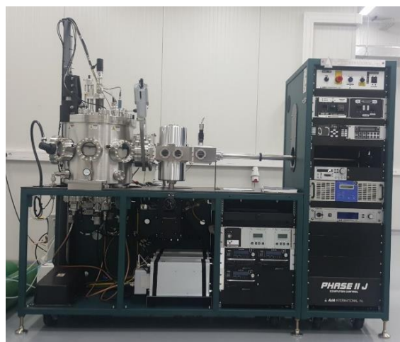
Fig. 1b Sistem de depunere a straturilor subțiri semiconductoare, AJA PHASE II J, prin pulverizare în câmp magnetron în regim RF, DC și p-DC.
