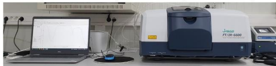
Fig. 3b Platformă de spectroscopie FTIR cu domeniu spectral extins NIR - MID - farIR, 12000 - 50 cm -1 .
