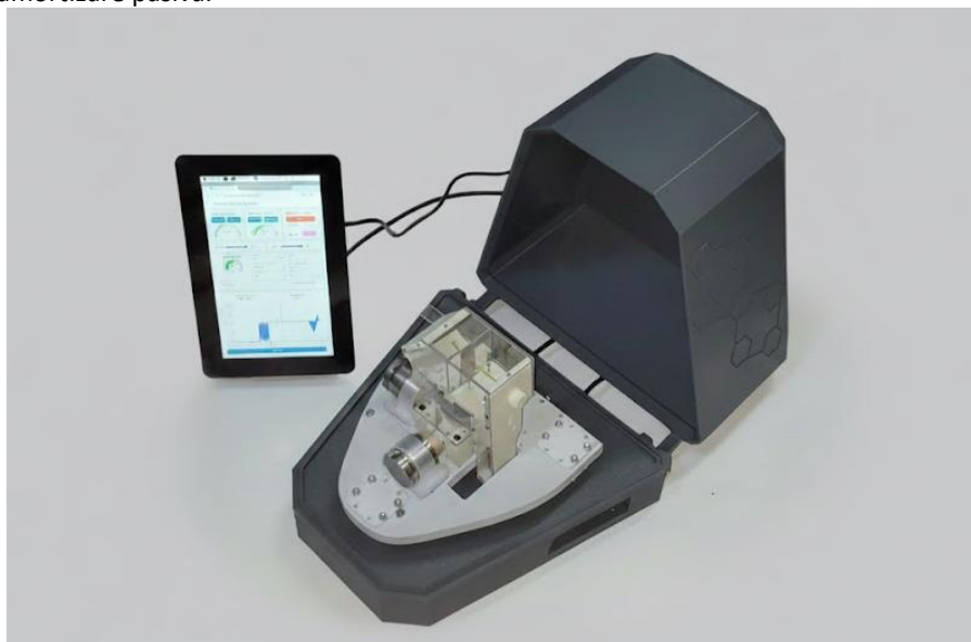
Figura 2. Fotografie a prototipului AFM realizat, cu interfața tactilă.
