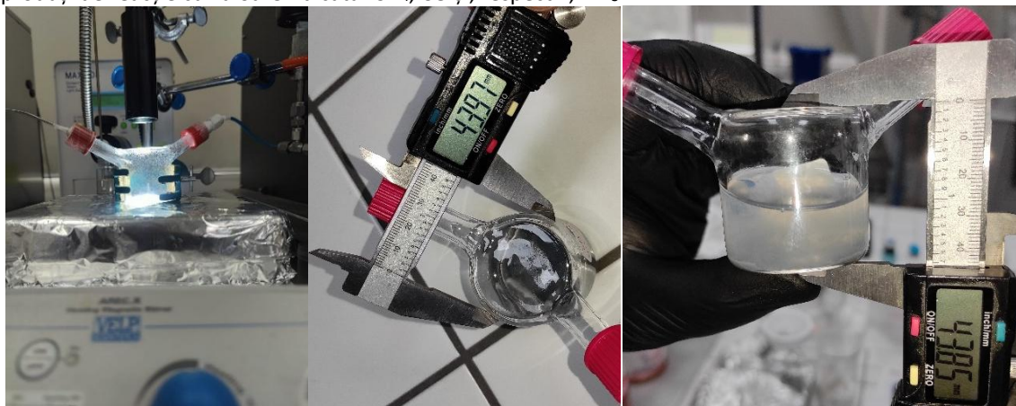
Figura 1. Imagini ale sistemului fotocatalitic utilizat în realizarea reacțiilor în fază lichidă și fază gazoasă, compus dintr-un fotoreactor și un sistem de iluminare MAX-303.
