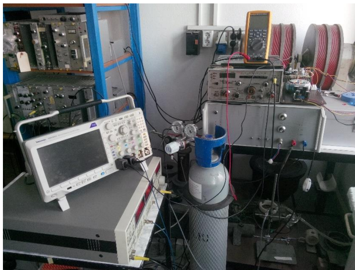
Figura 3: Montaj experimental pentru determinarea constantei de cuplaj ME.
