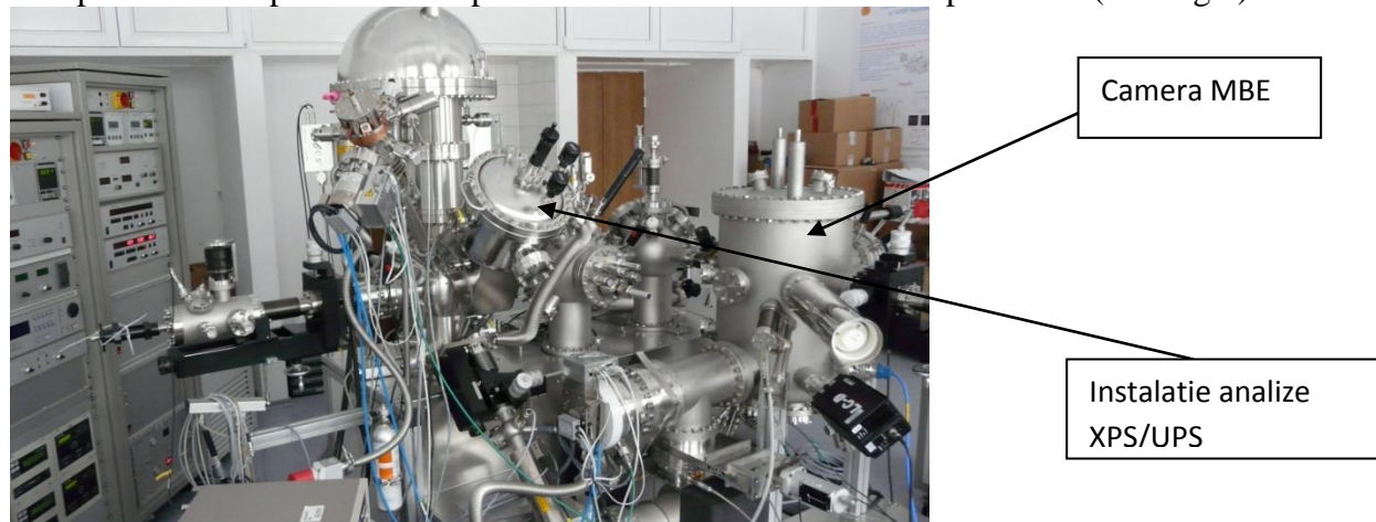
Fig. 1 Echipament complex de studio al interfetelor/suprafetelor dotat cu o camera MBE si cu analizor XPS/UPS.
