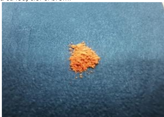
Fig.1. Imaginea, spectrele de reflectanță, excitare și fotoluminescența ale pulberii de (\text{MA})_3\text{Sb}_2\text{I}_9
