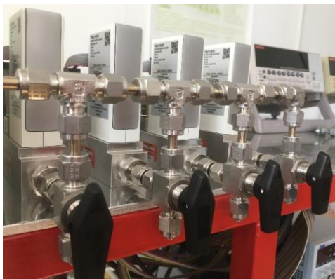
Figura 1. Schema de ansamblu a SMG (a); debitmetru de masă – Bronkhorst cu electrovalvă în aval inclusă (b); set piulițe și ferule ca elemente de strângere (c); robinet Swagelok cu trei căi (d); detaliu canale dedicate pentru dozarea acetonei în aer sintetic cu RH variabilă (e).
