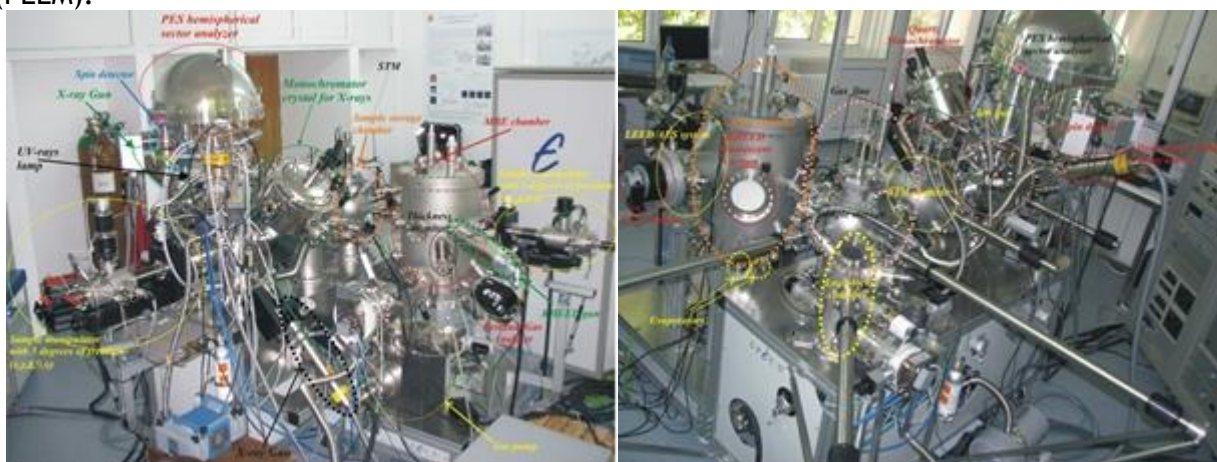
Figura 1. Fotografie și desemnarea principalelor elemente componente ale clusterului de știința suprafețelor, format din instalațiile de epitaxie din fascicul molecular, microscopie de baleiaj cu efect tunel și instalația de spectroscopie de fotoelectroni cu rezoluție unghiulară și de spin. Acest cluster a primit denumirea CoSMoS (Combined Spectroscopy and Microscopy on a Synchrotron) atunci când a fost conectat la linia de fascicul SuperESCA de la facilitatea de radiație de sincrotron Elettra, Trieste. Fabricant: Specs, Berlin, Germania.
