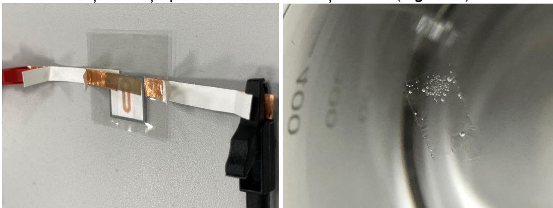
Fig. 10-1 Stânga - biosenzor pe suport de hârtie și sistem de electrozi metalici fibrilari obținuți prin electrofilare; dreapta - folie de grafenă/PMMA exfoliată electrochimic, pregătită de transfer.
