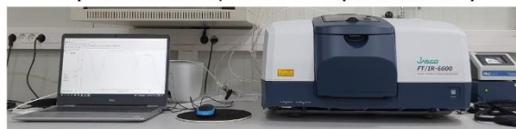
Fig. 20-3b Platformă de spectroscopie FTIR cu domeniu spectral extins NIR - MID - farIR, 12000 - 50 cm -1 .
