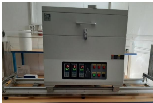
Fig. 60-4 Echipament de depunere prin transport în fază de vapori pentru dicalcogenicele metalelor tranziționale
