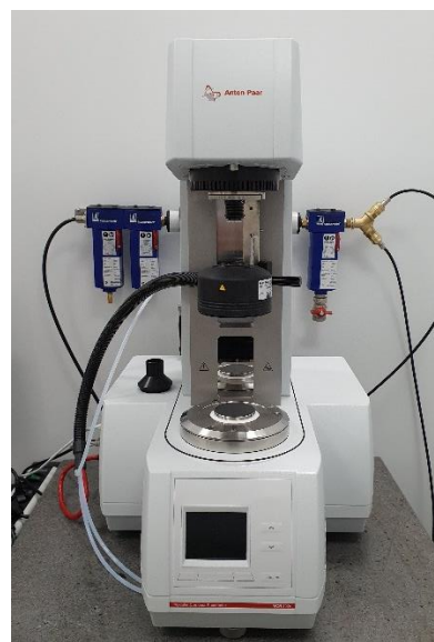
Fig. 20-2b Reometru modular ANTON PARR MCR302e.
