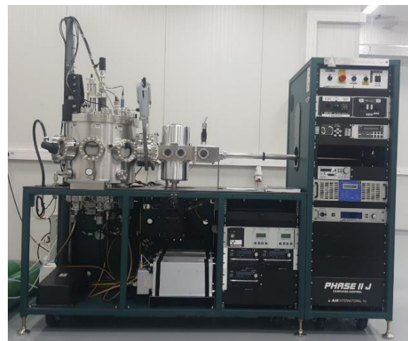
Fig. 20-1b Sistem de depunere a straturilor subțiri semiconductoare, AJA PHASE II J, prin pulverizare în câmp magnetron în regim RF, DC și p-DC.
