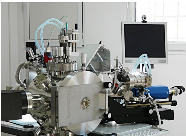
Fig. 20-1a Stație de lucru PLD, SURFACE SCIENCE, cu camera dedicată pentru depunerea de straturi subțiri feroelectrice.
