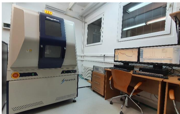
Fig. 20-3a Difractometrul de raze X pentru caracterizarea filmelor subțiri, model RIGAKU SmartLab 3 kW.
