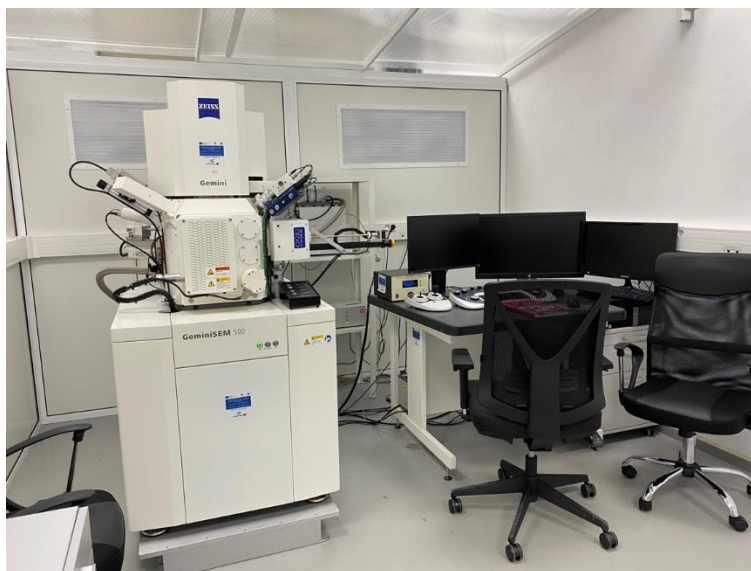
Fig. 10-2 Microscop electronic de baleiaj Zeiss Gemini 500.
