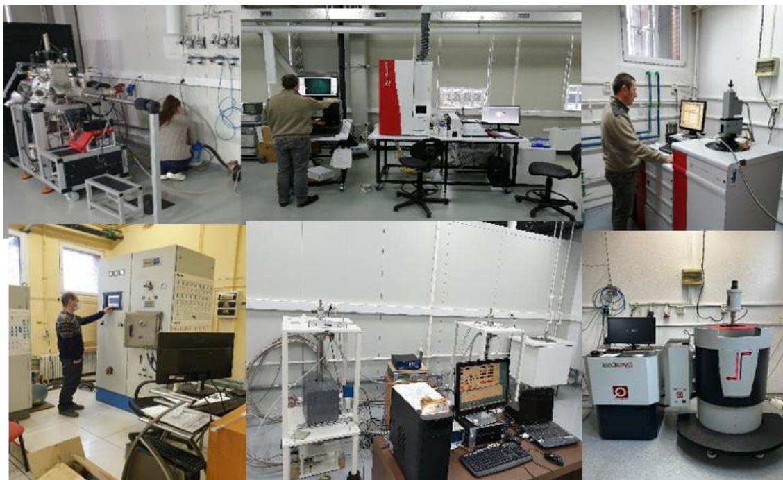
Fig. 30-1 Instalație RF magnetron-sputtering pentru depuneri/co-depuneri de filme subțiri cu patru ținte și instalație de sinterizare în plasmă (spark plasma sintering), utilizată pentru obținerea de materiale cu densitate ridicată, menținând caracteristicile nanostructurale (stânga); Sistem ICP-MS cu ablație laser pentru analiza filmelor subțiri și spectrometre Mössbauer echipate cu criostate cu circuit închis de heliu (mijloc); Dispozitive MPMS-SQUID și PPMS DynaCool, Quantum Design, de înaltă sensibilitate (dreapta).
