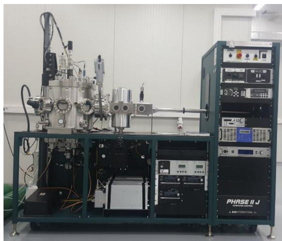
Fig. 20-1b Sistem de depunere a straturilor subțiri semiconductoare, AJA PHASE II J, prin pulverizare în câmp magnetron în regim RF, DC și p-DC.
