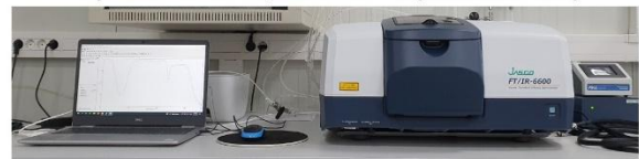
Fig. 20-3b Platformă de spectroscopie FTIR cu domeniu spectral extins NIR - MID - farIR, 12000 - 50 \text{ cm}^{-1} .
