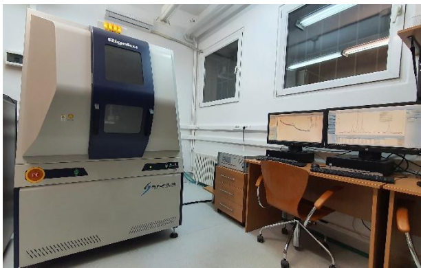
Fig. 20-3a Diffractometrul de raze X pentru caracterizarea filmelor subțiri, model RIGAKU SmartLab 3 kW.
